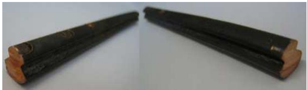
Рис. 2. Внешний вид провода МФ-85
