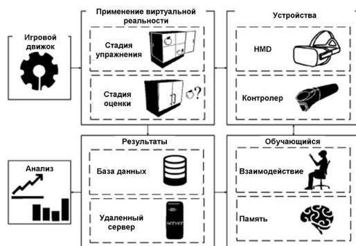
Рис. 2. Общая схема системы на основе погружающей виртуальной реальности (IVR)
