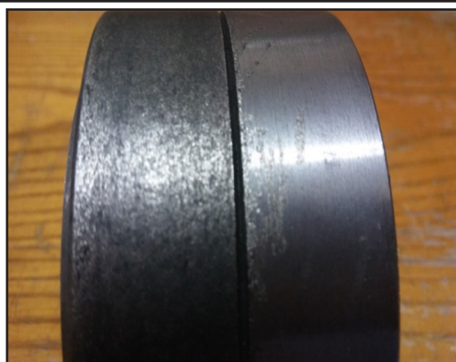
а) упрочненная часть; б) часть не упрочненная;
