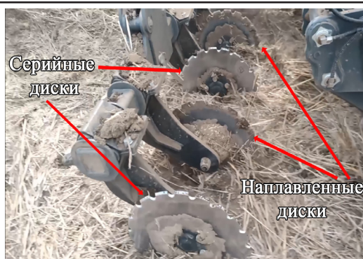
Рис. 1. Расстановка экспериментальных и контрольных образцов режущих дисков на передней раме посевого комплекса
