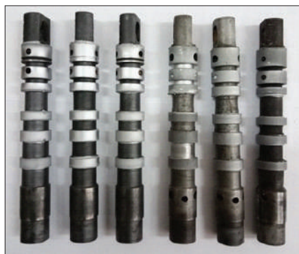
Рис. 1. Внешний вид золотников: a – подготовленных для хромирования; б – покрытых хромом
