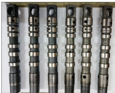
Рис. 1. Внешний вид золотников: a – подготовленных для хромирования; б – покрытых хромом
