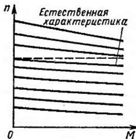
Рис. 3. Механические характеристики системы генератор - двигатель постоянного тока
