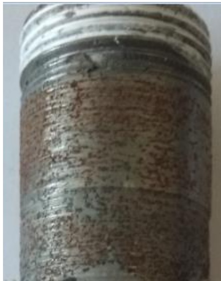
Рисунок 2 – Коррозированная поверхность образца
