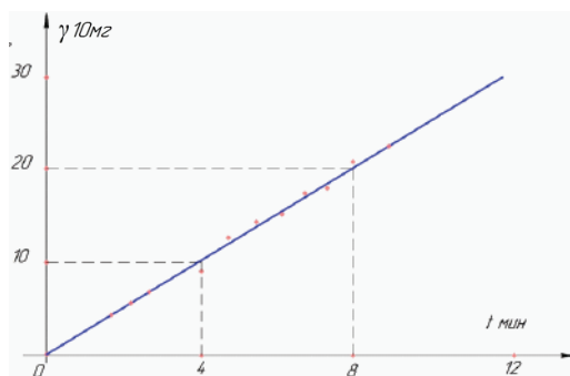
Рис. 6. Зависимость привеса катода из титана от времени электроискрового легирования алюминием при вращающемся аноде
