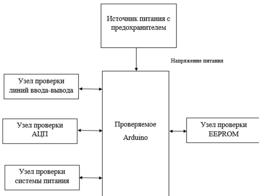
Рис. 2. Структурная схема лабораторного стенда
