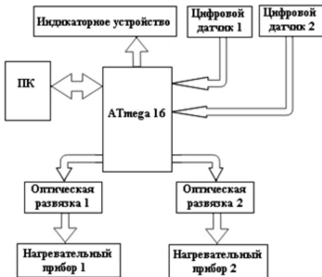
Структурная схема устройства управления технологическими режимами
