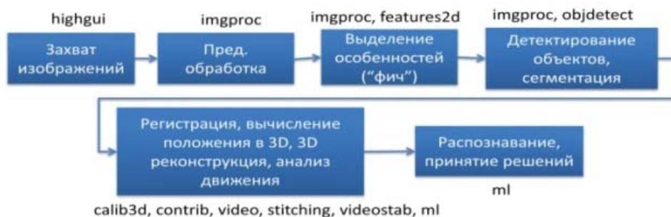
Рис. 1. Общая схема приложения с использованием компьютерного зрения
